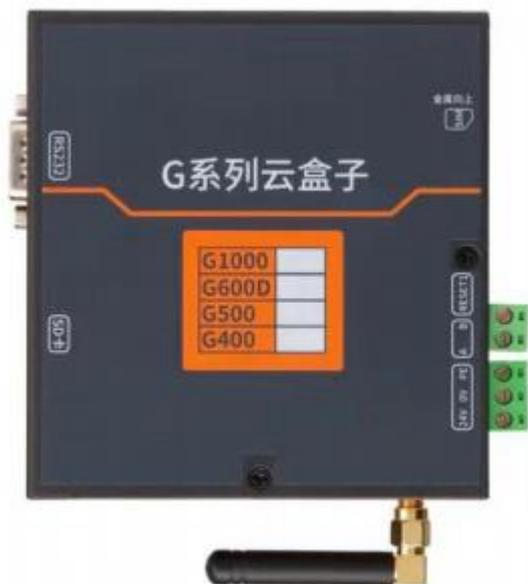
收到我们设备后先安装好4G卡（芯片朝上，缺口朝外），连接天线，先插卡，后上电，不能在设备运行状态下拔插卡。如果是选择网口上网忽略这一步。
